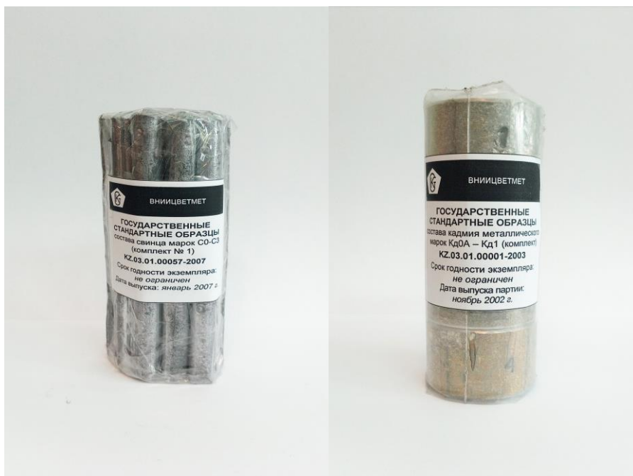
Рис. 1. Государственные стандартные образцы состава свинца марок С0-С3 (комплект № 1) KZ.03.01.00057-2007
