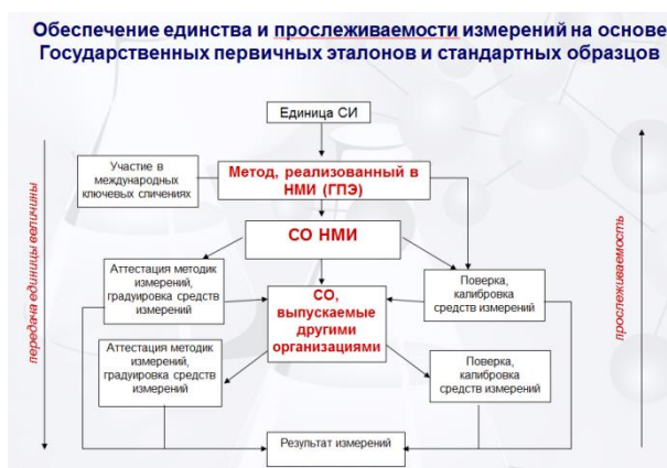
Рис. 3 Общая схема обеспечения единства и прослеживаемости измерений на основе ГЭТ и СО.
