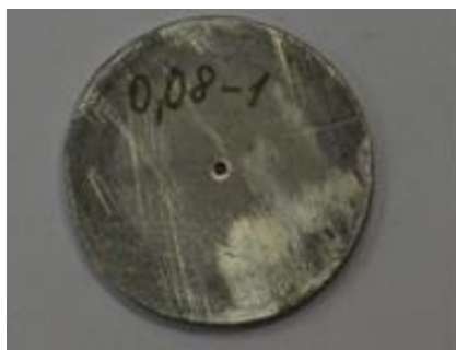
Рис.2. Поверяемое критическое микросопло контрольной течи «КТ2-АКУСТИКА», площадь поверяемого критического микросопла - 0,2 мм 2 .
