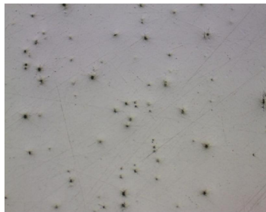
Рисунок 2. Область пористости в отливке жаропрочного никелевого сплава [3]
