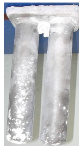
Рисунок 4. Заготовки СО никелевого сплава, полученные методом направленной кристаллизации [3]
