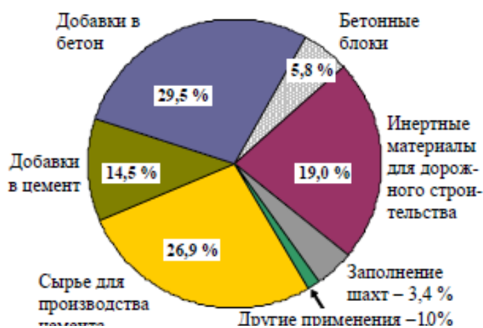
Рис. 1. Использование летучей золы при производстве строительных материалов и проведении шахтных работ в Европе (общий объем использования – 20,0 млн т.)
